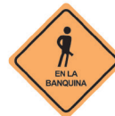
T 8 TRABAJOS EN BANQUINA
